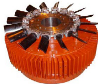
Ein komplettes lüftergekühltes vertikales Lager inklusive PTFE-Kippsegmenten
